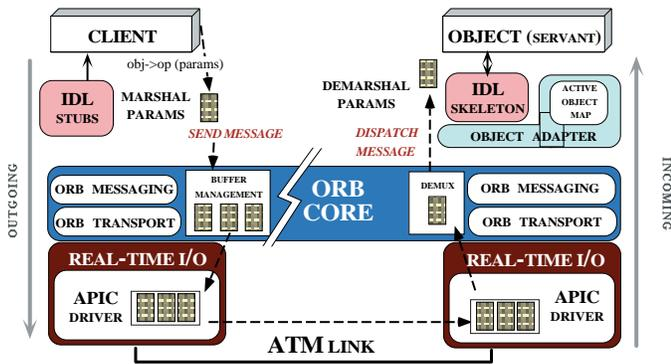
Figure 9: Real-Time ORB Endsysteem Example
